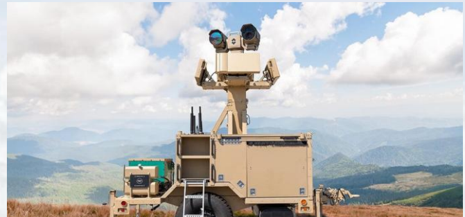
Sistema C-UAS – interferencia electromagnética
